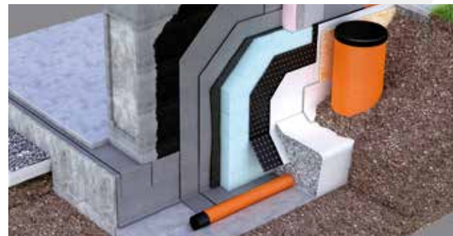
Řešení svislé plošné drenáže zaústěné do obvodového svodného drénu s osazenou kontrolní šachtou Vertical systematic drainage opening into a perimeter drain with an installed shaft pipe
