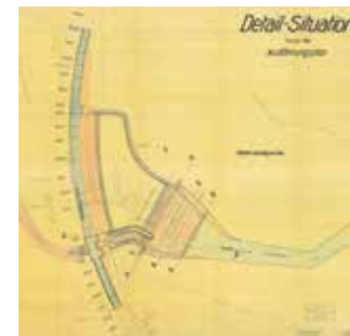
Situace výstavby hráze VD Naděje z roku 1938, původní projekt, který byl jedním z podkladů pro návrh rekonstrukce Site plan of the construction of the Naděje Waterwork from 1938; the original project provided source documents for the renovation project.
