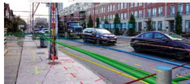
Užití rozšířené virtuální reality ve spojení s 3D modelem inženýrských sítí města Use of extended virtual reality linked to a 3D model of a municipal technical infrastructure
