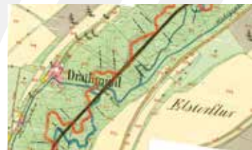
Mapa se zachycením tří stavů koryta – modře zakreslena původní trasa podle stabilního katastru, černé linie – trasa po úpravě potoka před revitalizací, červené linie – trasa po revitalizaci Map tracing three states of the basin – blue is the original trace according to the stable cadaster; black is the trace after the creek was revitalized, before the revitalization; red line – the trace after the revitalization.
