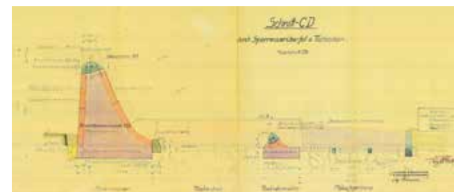
Příčný řez konstrukcí tělesa hráze v místě přelivu, patrná železobetonová přelivná hrana Cross-section through the dam structure at the spillway; notated is the reinforced concrete crest of weir.
