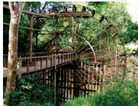
Vodní kolo hnané proudem řeky Siem Reap, které vynáší vodu do zavlažovacího systému A water wheel driven by the stream of the river Siem Reap supplying water to the irrigation system.
